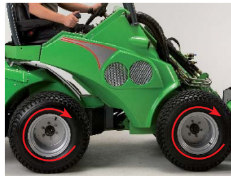
سیستم کنترل هیز گردی
