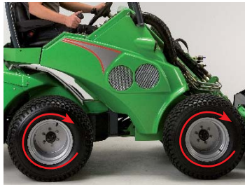
سیستم کنترل هرز گردی
